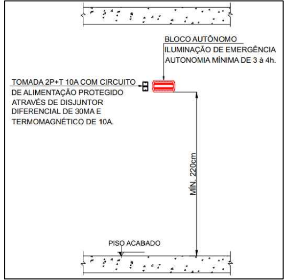
DETALHAMENTO DOS PONTOS DE INSTALAÇÃO DE BLOCOS AUTÔNOMOS DE ILUMINAÇÃO DE EMERGÊNCIA
